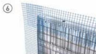
**FINA MALLA** Suministrada de forma estándar junto con la estructura, la malla de fibra de vidrio, aplicada entre la estructura de metal y la pared de ladrillos, evita que se formen grietas en la zona cuando se asienta el yeso.
